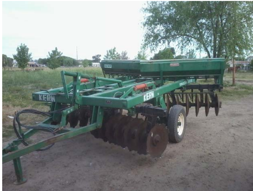
Foto 2: Rastra de doble acción con cajón sembrador para siembra convencional de cereales invernales y Trébol de olor.
