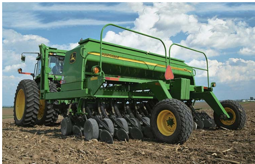
Foto 3: Sembradora de grano fino para siembra directa. En la tolva de fertilizantes Trébol de olor Blanco para siembra consociada.
