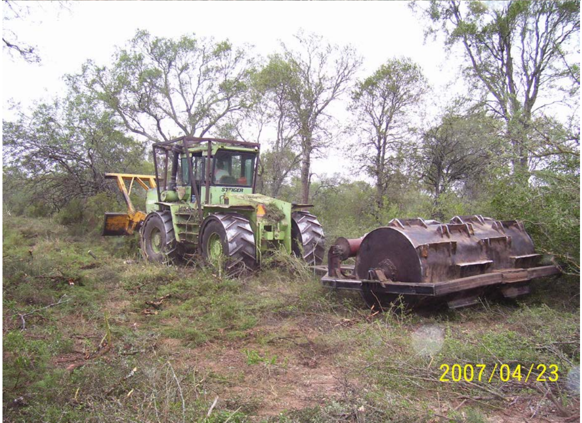
Foto 12: Foto 12.1: Rolo picador con tacho sembrador, Finca La Esperanza, Matará, Depto. Taboada, Stgo. del Estero. Foto 12.2: Tractor en desbajado de monte con implantación de forrajeras, Finca El Itín, Matará, Depto. Taboada, Stgo. del Estero. Fotos: JRTV.
