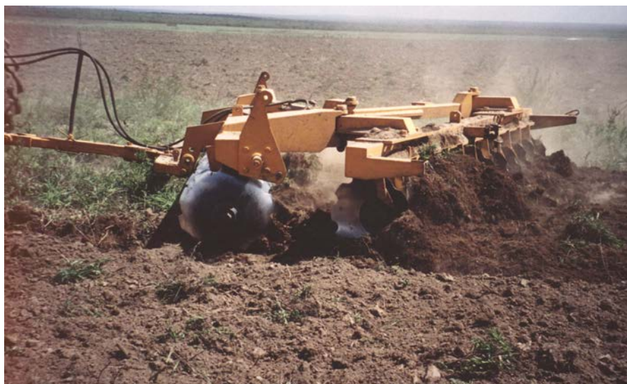
Foto 2: Equipos de preparación de suelos Foto 2.1: Escarificador profundo (60 cm prof); Foto 2.2: Scoltie o cultivie (40 cm prof); Foto 2.3: Rastra semipesada (30 cm prof). Fotos: JRTV.
