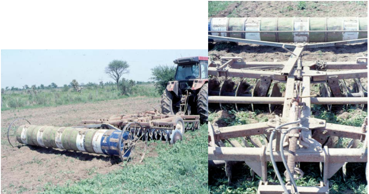
Foto 7: Foto 7.1: Siembra al voleo de Grama Rhodes cv. Callide con rastra y tachos sembradores; Foto 7.2: Detalle del tandem rastra-tachos sembradores, Estancia La Celina, Depto. Río Hondo, Stgo. del Estero. Fotos: JRTV.
