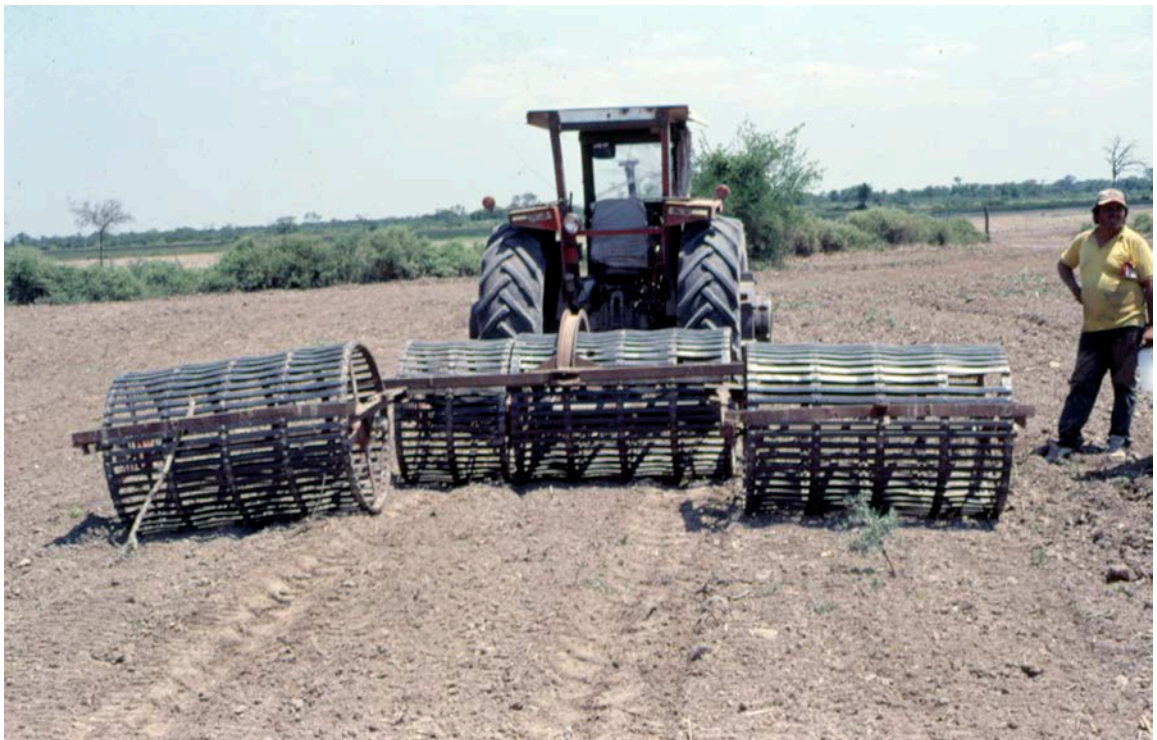
Foto 9: Rolos compactadores en siembra de pasturas. Finca Cachi Yaco, Depto. Leales, Tucumán y Estancia La Celina, Depto. Río Hondo, Sgo. del Estero. Fotos: JRTV.
