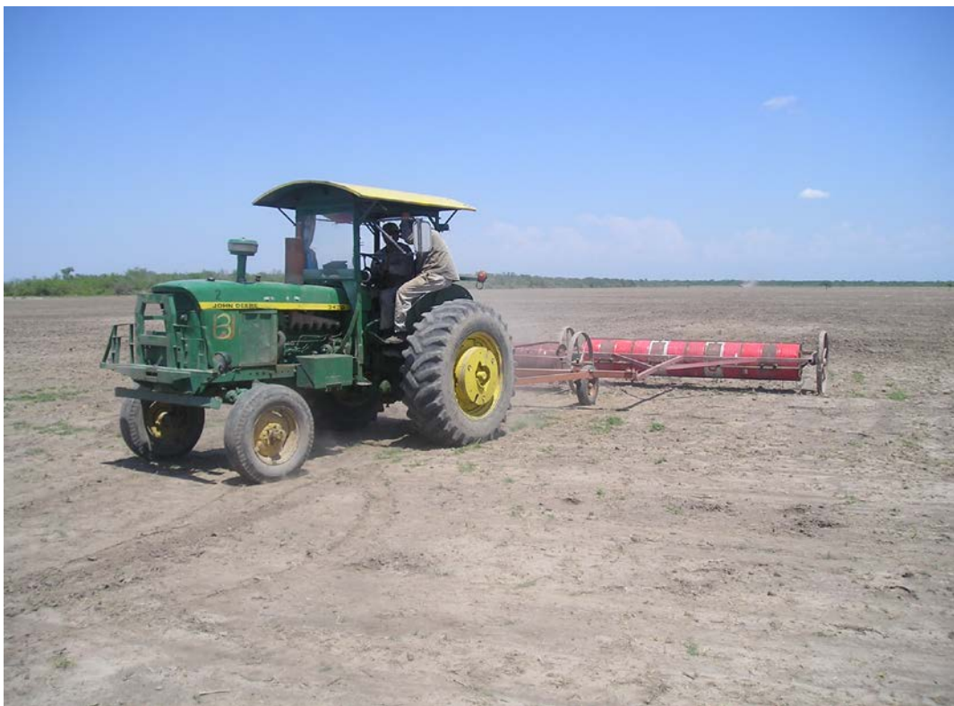
Foto 8: Foto 8.1: Enganche para tandem de sembradoras de tachos para Grama Rhodes; Foto 8.2: Tandem de 2 sembradoras, Finca Cachi Yaco, Depto. Leales, Tucumán. Fotos: JRTV.
