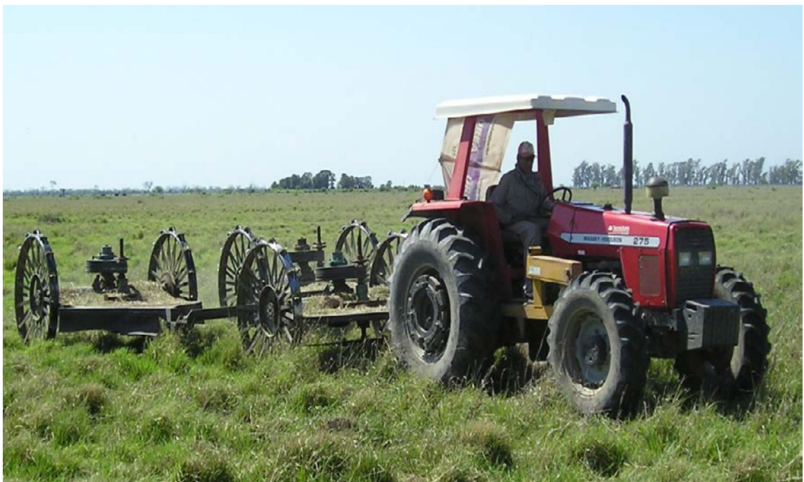
Foto 19: Foto 19.1: Desmalezadoras de arrastre Inroda en tandem. Foto 19.2: Equipo desmalezadotas en tandem sobre Grama Rhodes cv. Fine Cut. Haciendas del Valle, El Porvenir, Depto. Jiménez, Stgo. del Estero. Fotos: JRTV.
