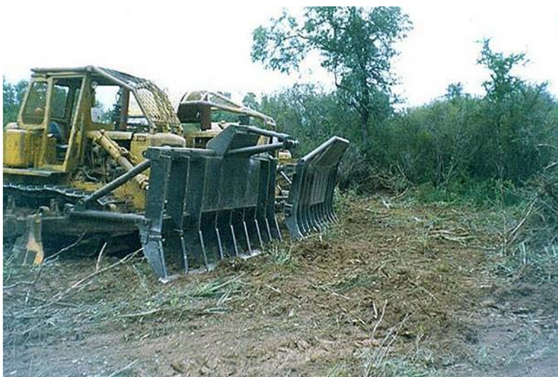
Figura 8: Topadoras para desmonte mecánico.
